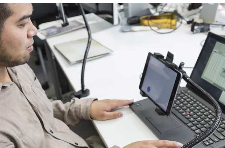
▶ 発達障害の診断を補助するアセスメントツール。 手前のタブレットに表示される、動く青い点を目で追わせる。
